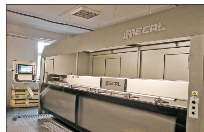
Czteroosiowe centrum obróbkowe CNC MECAL służy do obróbki aluminiowych elementów balustrad
